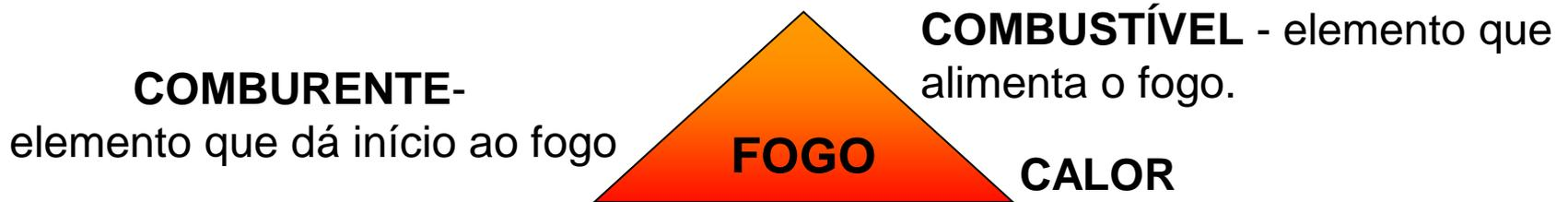
Conhecendo o triângulo do fogo, concluímos que para a correta extinção do fogo basta eliminar um dos três elementos.
